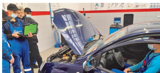
Obsługa testera diagnostycznego KTS firmy Bosch - to nieodzowny element pracy współczesnego mechanika.
